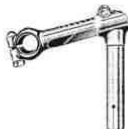
1505. Attacco Ambrosio Champion da mm. 24 in dural, forgiato graduabile, con bulloni.
