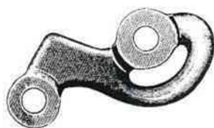
S 63. Controflangia in acciaio stampato del cambio 1949/50.
