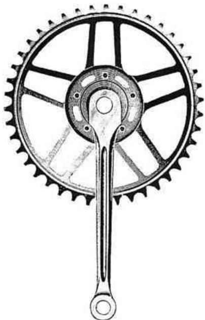
1953. Guarnitura W.A. a 5 viti per carter, 40-42 denti 1/2 \times 1/8 , cromata.
