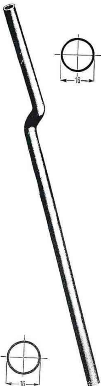
3245. Tubi posteriori verticali P 7, piegati tondi-tondi mm. 16.
